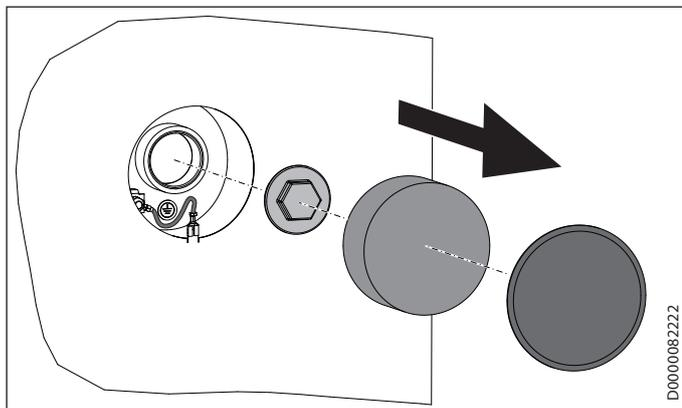
Установить электрический ввинчиваемый нагреватель HP-SB 2/040
